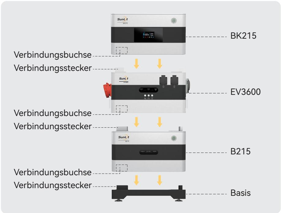
Abbildung 5-1 Produktinstallation
