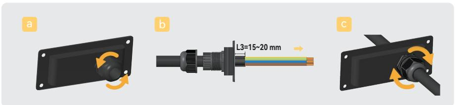
Abbildung 5-5 Installation des Kabels
