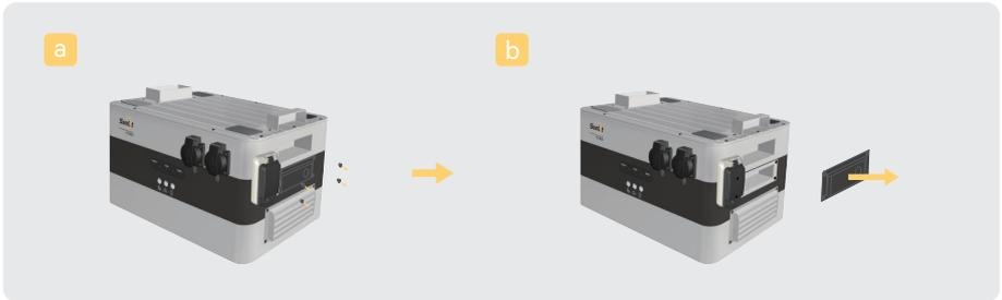
Abbildung 5-3 EV3600 Abnehmen der Kabelhalterung
