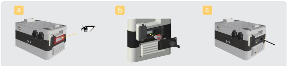
Abbildung 5-7 Anbringen des Schnellanschlusssteckers
