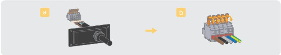
Abbildung 5-6 Kabelverbindung mit Schnellanschlussstecker
